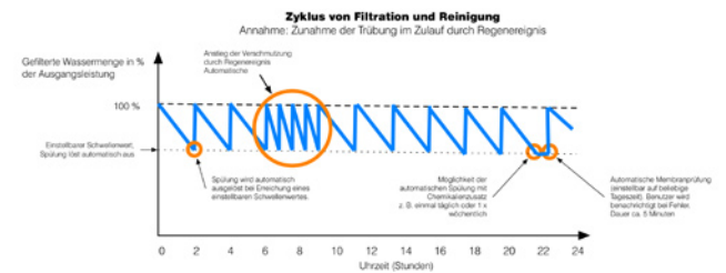
Abbildung 6: Automatische Reinigung der Anlagen, im Betrieb ohne Chemie.
